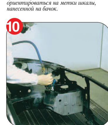
Стравливание воздуха необходимо только в том случае, если распылять краску придется в перевернутом положении окрасочного пистолета.
