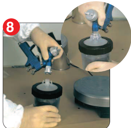
Переверните окрасочный пистолет, опустите в бачок и закрепите переходник на крышке.
