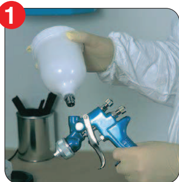
Снимите бачок с окрасочного пистолета.
