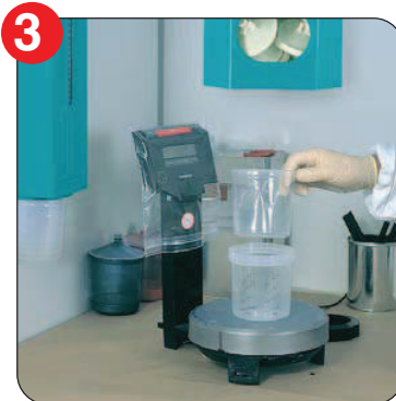
Извлеките из настенного диспенсера пластиковый стакан и вложите его в смесительный бачок.
