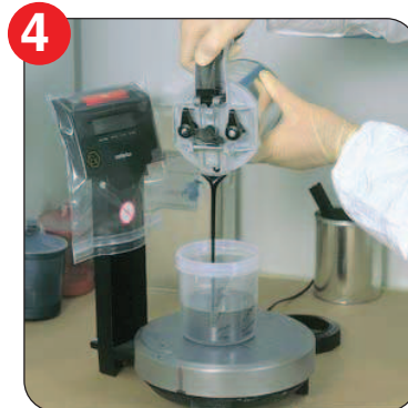
Влейте в бачок отмеренное количество краски. При этом можно ориентироваться на метки шкалы, нанесенной на бачок.
