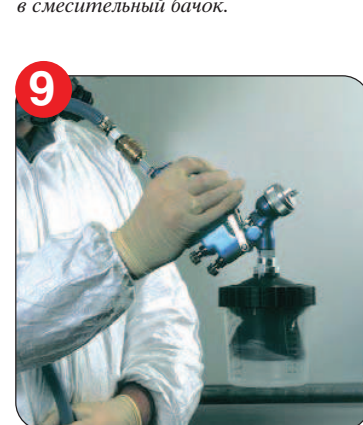
Присоедините окрасочный пистолет к воздуховоду, переверните окрасочный пистолет в рабочее положение и курком спускового механизма стравите воздух из стакана.
